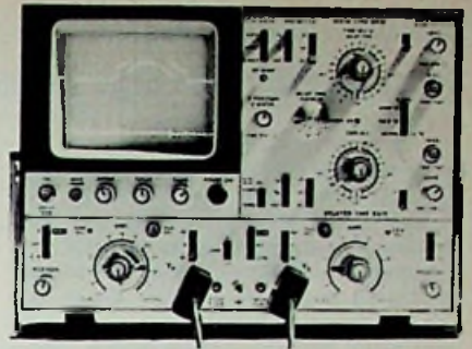
Afb. 1. De nieuwe Philips oscilloscoop PM 3252, de eerste ter wereld met ingebouwde mogelijkheid tot vermenigvuldigen (tot 35 MHz).
