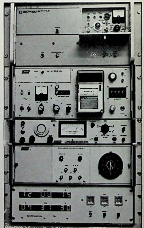
Afb. 4: Primaire (cesium) frequentie-tijdstandaard met vergelijkingsapparaat en klok.
